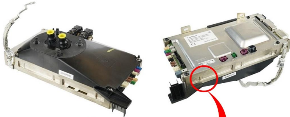
【 그림4. 테슬라 HW3.0 AI 컴퓨터 구성 (컴퓨터 어셈블리 ▶ 컴퓨터 보드 ▶ 컴퓨터 칩) 】
