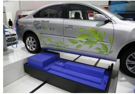
<그림 3> 좌: Hertz가 시범운영중인 비접촉식 충전 우: 프로젝트 Betterplace의 교체형 배터리시스템
